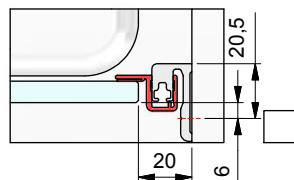
d) mit Dichtprofil 8861KU0-8 und Türanschlag-Trägerprofil 8880
