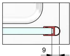
b) mit Dichtprofil 8851KU0-8 und Türanschlag-Trägerprofil 8880
