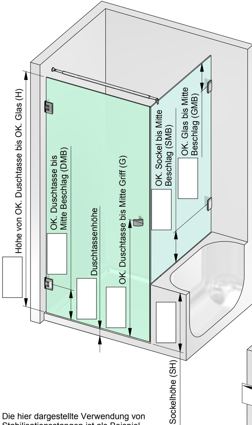
Die hier dargestellte Verwendung von Stabilisierungsstangen ist als Beispiel anzusehen. Größe und Position der Stabilisierungsstangen ist abhängig von der Glasgröße!
