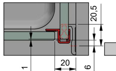
c) mit Dichtprofil 8861KU0-8 und Türanschlag-Trägerprofil 8880
