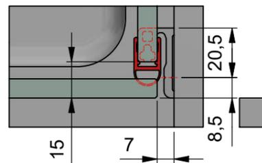
d) mit Dichtprofil 8861KU0 und Türanschlag z.B. 8274
