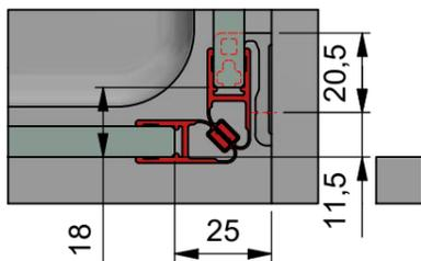
b) mit Dichtprofil 8855KU0-8 und Türanschlag-Trägerprofil 8880
