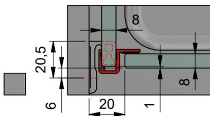
c) mit Dichtprofil 8861KU0-8 und Türanschlag-Trägerprofil 8880
