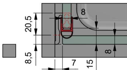
d) mit Dichtprofil 8861KU0-8 und Türanschlag z.B. 8274
