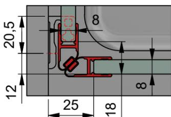
b) mit Dichtprofil 8855KU0-8 und Türanschlag-Trägerprofil 8880
