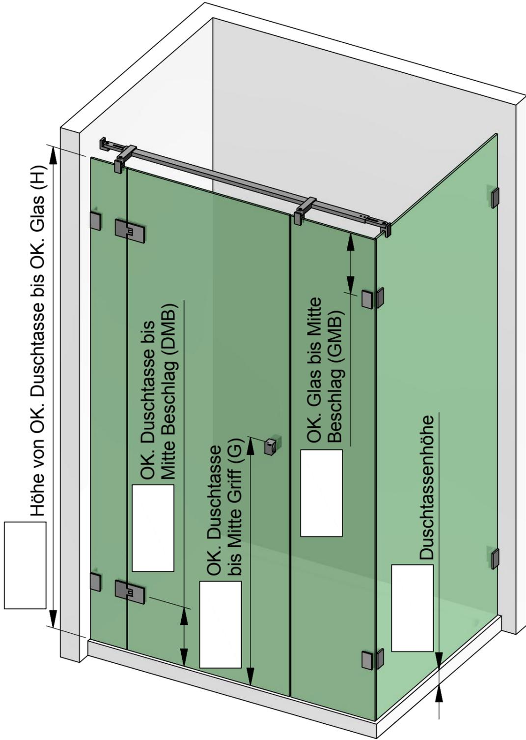
Die hier dargestellte Verwendung von Stabilisationsstangen ist als Beispiel anzusehen. Größe und Position der Stabilisationsstangen ist abhängig von der Glasgröße!
