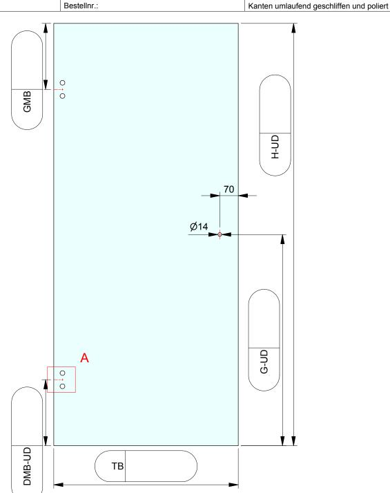
ESG 8mm klar gefertigt nach DIN EN14428 (Duschenglas). Ein entsprechender Nachweis(Stempel) ist erforderlich. Kanten umlaufend geschliffen und poliert. Alle Ecken stoßen oder leicht runden.
