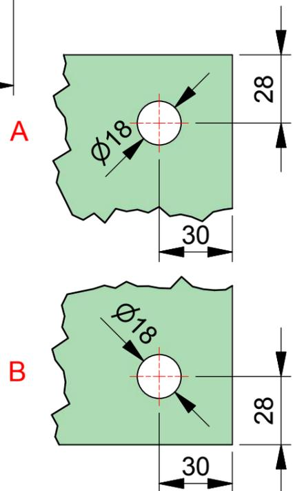
ESG klar gefertigt nach DIN EN14428 (Duschglas). Ein entsprechender Nachweis(Stempel) ist erforderlich. Kanten umlaufend geschliffen und poliert. Alle Ecken stoßen oder leicht runden.
