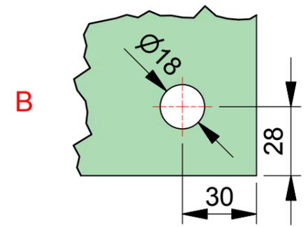
ESG klar gefertigt nach DIN EN14428 (Duschglas). Ein entsprechender Nachweis(Stempel) ist erforderlich. Kanten umlaufend geschliffen und poliert. Alle Ecken stoßen oder leicht runden.
