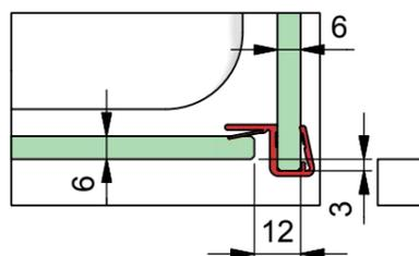
Verstellbereich für den Türflügel bei den unterschiedlichen Überlappungen (Ü). Mindestüberlappung sollte aus Gründen der Dichtigkeit nicht unterschritten werden.
