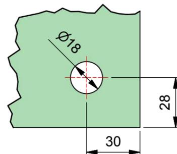
ESG klar gefertigt nach DIN EN14428 (Duschglas). Ein entsprechender Nachweis(Stempel) ist erforderlich. Kanten umlaufend geschliffen und poliert. Alle Ecken stoßen oder leicht runden.
