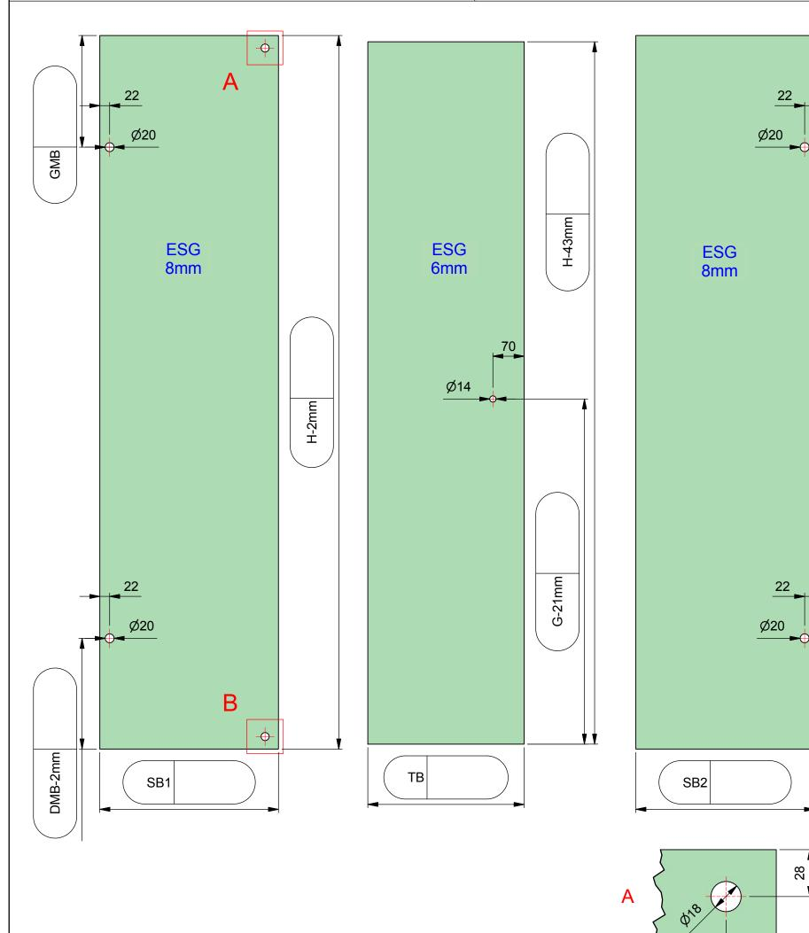
ESG klar gefertigt nach DIN EN14428 (Duschenglas). Ein entsprechender Nachweis(Stempel) ist erforderlich. Kanten umlaufend geschliffen und poliert. Alle Ecken stoßen oder leicht runden.
