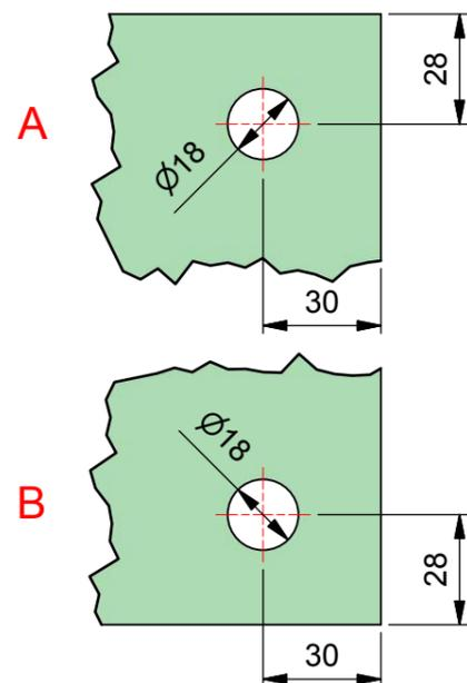
ESG klar gefertigt nach DIN EN14428 (Duschglas). Ein entsprechender Nachweis(Stempel) ist erforderlich. Kanten umlaufend geschliffen und poliert. Alle Ecken stoßen oder leicht runden.
