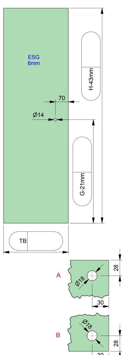
ESG klar gefertigt nach DIN EN14428 (Duschenglas). Ein entsprechender Nachweis(Stempel) ist erforderlich. Kanten umlaufend geschliffen und poliert. Alle Ecken stoßen oder leicht runden.
