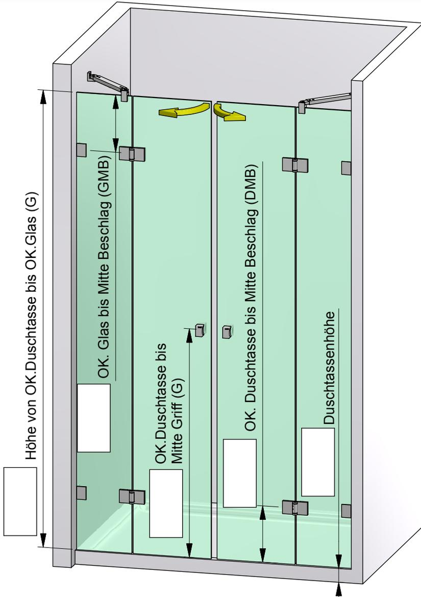
Die hier dargestellte Verwendung von Stabilisierungsstangen ist als Beispiel anzusehen. Größe und Position der Stabilisierungsstangen ist abhängig von der Glasgröße!
