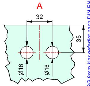
ESG 8mm klar gefertigt nach DIN EN14428 (Duschenglas). Ein entsprechender Nachweis(Stempel) ist erforderlich. Kanten umlaufend geschliffen und poliert. Alle Ecken stoßen oder leicht runden.
