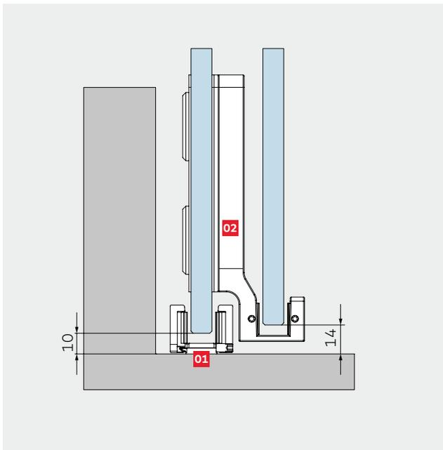
**Glasbearbeitung für mitfahrende Bodenführung am Langsamläufer**
