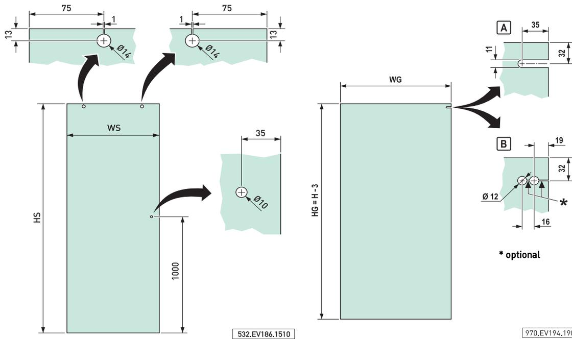
Die Glasbohrung mit dem Durchmesser von 10 mm ist nur bei Verwendung des Aquant-Griffs vorzunehmen.
