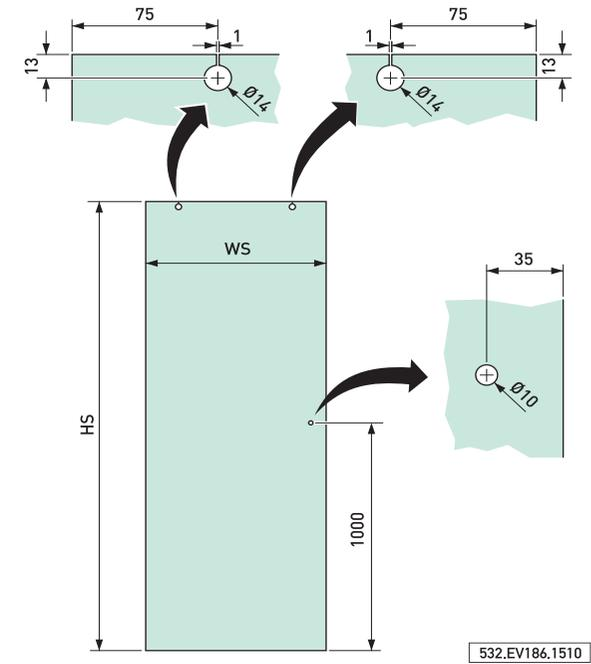
Die Glasbohrung mit dem Durchmesser von 10 mm ist nur bei Verwendung des Aquant-Griffs vorzunehmen.
