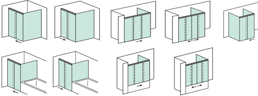
Einbausituationen mit ausziehbarem Spritzschutz
