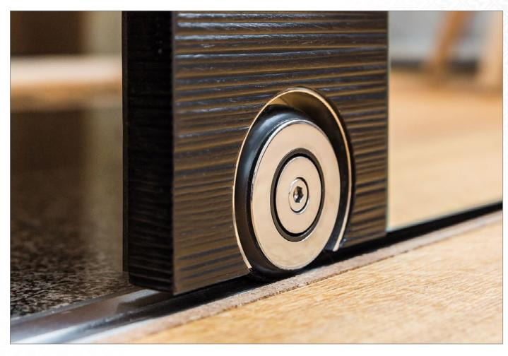
Durch das Drehen der Kunststoffhülse kann man die Höhe um +/- 1,5 mm einstellen.
