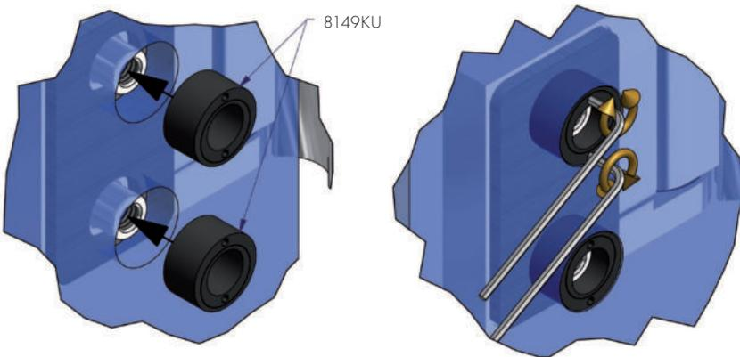
Durch den Einbau des Doppelexzentereinsatzes kann das Glas besser zentriert und dauerhaft positioniert werden.
