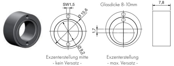
Winkel frei wählbar, Verstellung mittels Innensechskantschlüssel SW1,5mm
