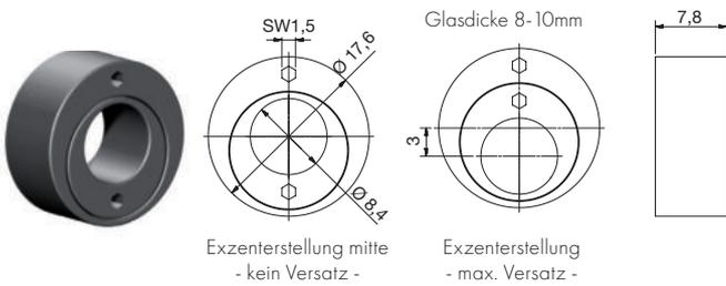
Exzenterstellung frei wählbar, Verstellung mittels Innensechskantschlüssel SW1,5mm
