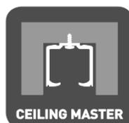
**CEILING MASTER** Die perfekte Lösung für alle Deckenmontagen: Ermöglicht problemlos jede Deckenmontage – selbst in der Deckennut, vor dem Sturz oder in einer Abhangdecke. Selbstverständlich sind auch zweiseitige Lösungen und Lösungen mit Festflügel möglich.
