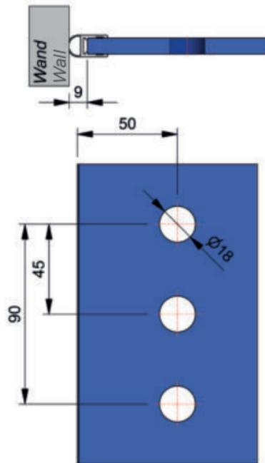
Glasbearbeitung für 10 mm Glas mit Dichtprofil 8861KU0-12
