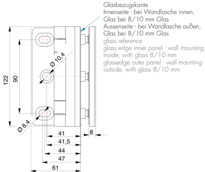
Glasbearbeitung für 8mm Glas mit Dichtprofil 8861KU0-8
