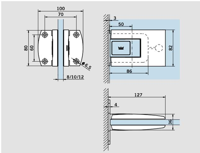
**Paar Pendeltürbänder inkl. Montageplatte, rund; zur Wand-/Zargenbefestigung mit aufliegender Montageplatte für 8, 10 und 12 mm Glas**
