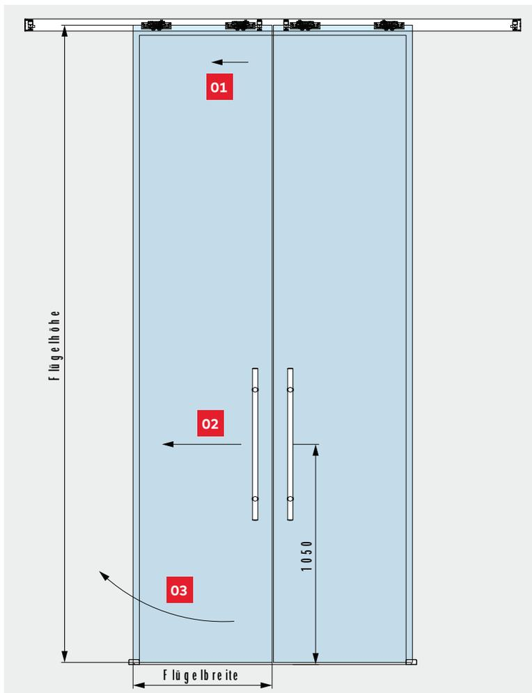
Zu hohe Schiebeflügel im Verhältnis zur Flügelbreite können physikalisch bedingt zu einer unangenehmen Handhabung und Fehlfunktion führen (Empfehlung des Seitenverhältnisses: zwischen 1:2 und 1:3).
