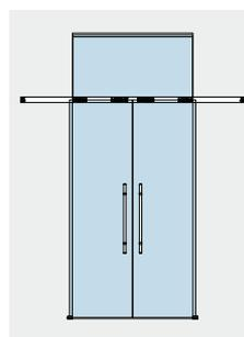
Wir empfehlen in solchen Fällen die Anwendung an Glas zu nutzen und ein Oberlicht einzusetzen. Dadurch wird die Türhöhe verringert und das Seitenverhältnis verbessert.
