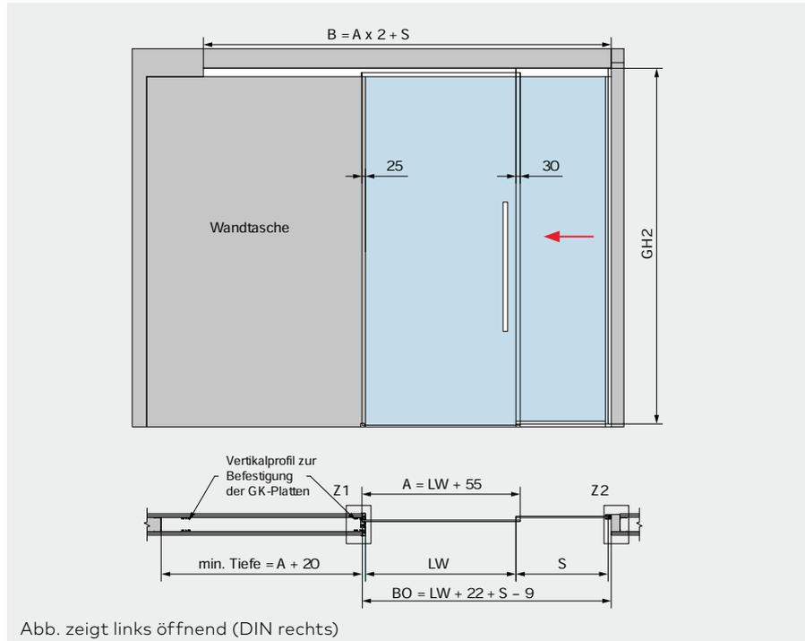
Abb. zeigt links öffnend (DIN rechts)
