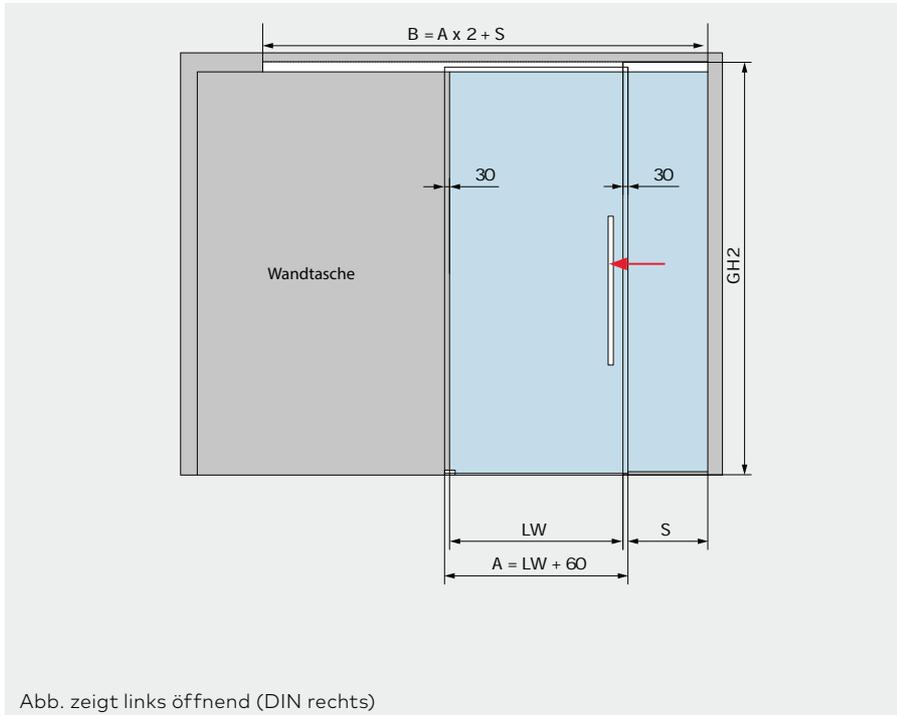
Abb. zeigt links öffnend (DIN rechts)
