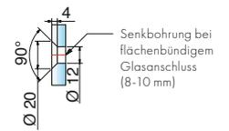
Senkbohrung bei flächenbündigem Glasanschluss (8-10 mm)
