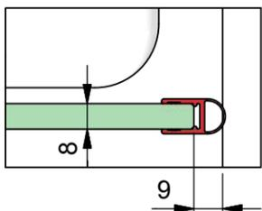
b) mit Dichtprofil 8851KU0-8 und Türanschlag-Trägerprofil 8880
