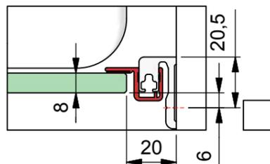
d) mit Dichtprofil 8861KU0-8 und Türanschlag-Trägerprofil 8880
