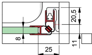
c) mit Dichtprofil 8855KU0-8 und Türanschlag-Trägerprofil 8880
