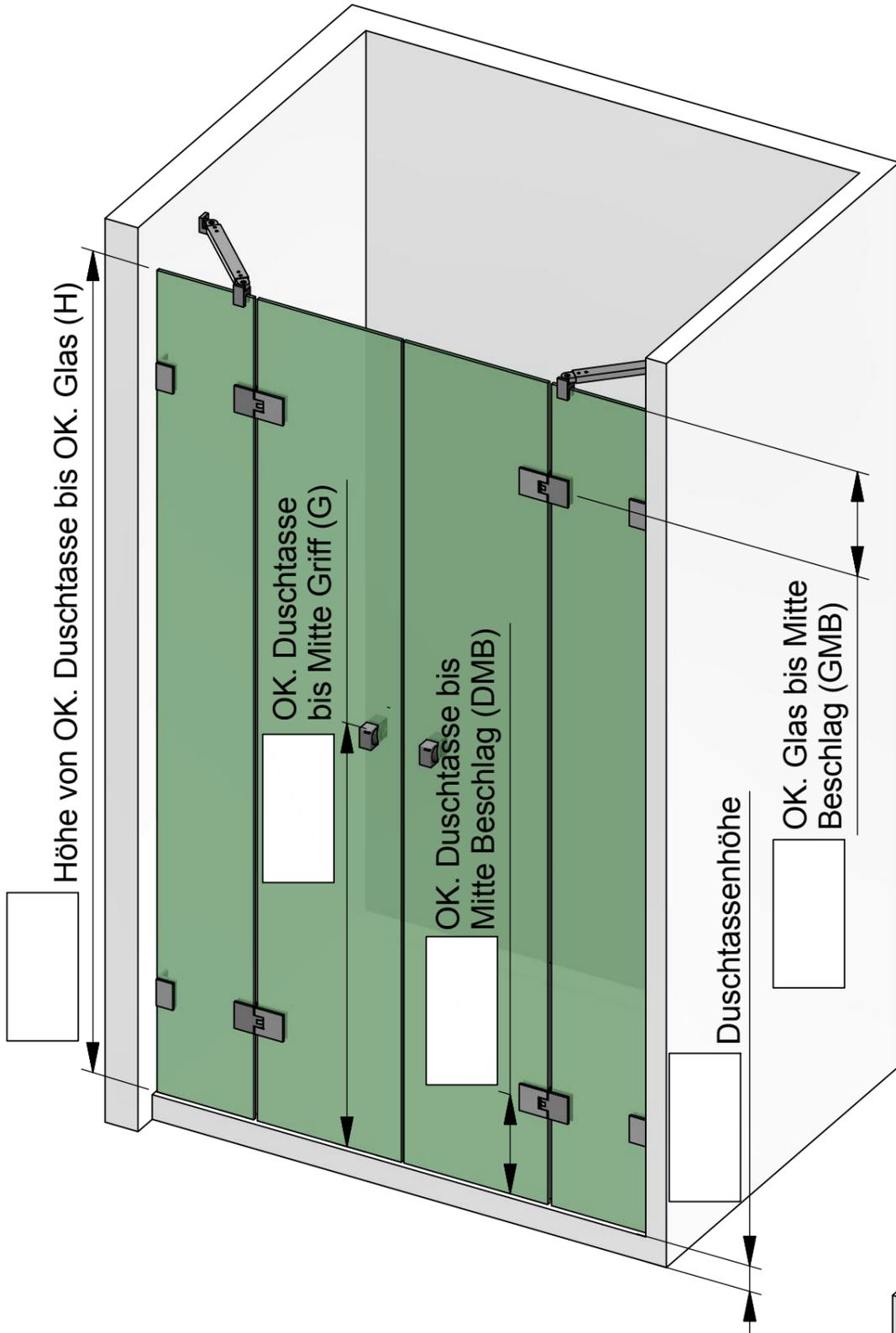
Die hier dargestellte Verwendung von Stabilisierungsstangen ist als Beispiel anzusehen. Größe und Position der Stabilisierungsstangen ist abhängig von der Glasgröße!
