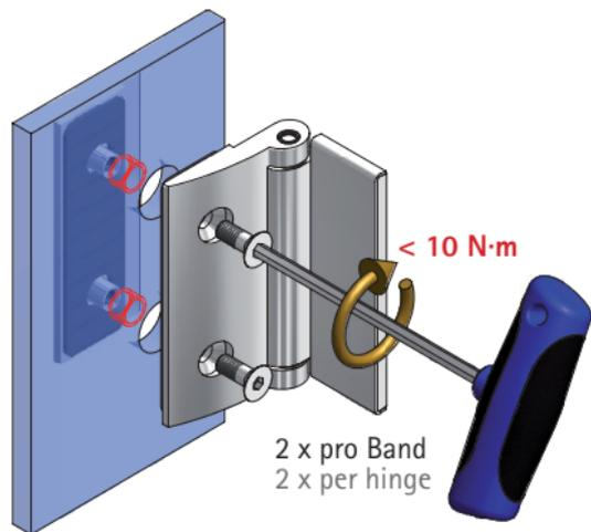
Bitte bei der Montage die Zapfen der Gegenplatten mittig in den Glasbohrungen positionieren, um den grösstmöglichen Verstellbereich für die Einstellung der Dusche zu gewährleisten.
