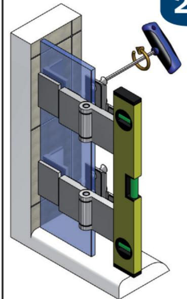
Die Zapfen der Gegenplatten mittig im Glasausschnitt positionieren, um den grösstmöglichen Verstellbereich für die Einstellung der Dusche zu gewährleisten. | The entry pilot of the counter plate should be focus central in the glass part to maximize the setting range for adjustment of the shower.
