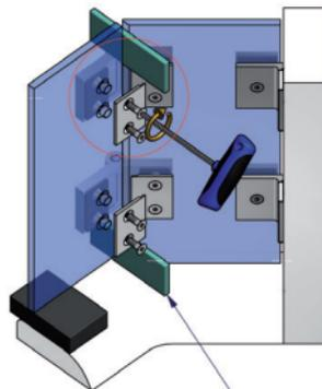
6 mm Glaserklötzchen um ein Anschlagen der Gläser bei der Montage zu verhindern. Diese stellen zugleich das Abzugsmaß sicher. | 6 mm block to avoid to hit the ground while mounting the glass. Those will be also the measurement for gap between glasses.
