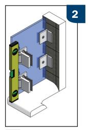
Die Zapfen der Gegenplatten mittig im Glasausschnitt positionieren, um den grösstmöglichen Verstellbereich für die Einstellung der Dusche zu gewährleisten. | The entry pilot of the counter plate should be focus central in the glass part to maximize the setting range for adjustment of the shower.
