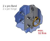
Um den späteren Abstand für die untere Dichtungslösung sicherzustellen, sollte der Türflügel mit Montageklötzen in der Höhe des beabsichtigten Abzugsmasses unterklotzt werden. Wechselweise bis zum Erreichen des max. Anzugsmomentes von 10 N·m anziehen. Nach ca. 15 Minuten nocheinmal wechselseitig auf das max. Anzugsmoment nachziehen.
