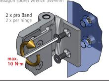
Wechselweise bis zum Erreichen des max. Anzugsmomentes von 10 N·m anziehen.
