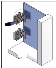
Bitte bei der Montage die Zapfen der Gegenplatten mittig in den Glasbohrungen positionieren, um den grösstmöglichen Verstellbereich für die Einstellung der Dusche zu gewährleisten.
