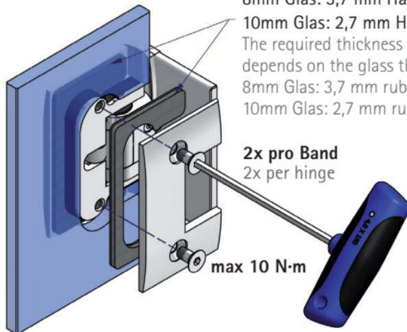
Die Dicke der einzusetzenden Hartzelleinlagen richtet sich nach der verwendeten Glasstärke:
