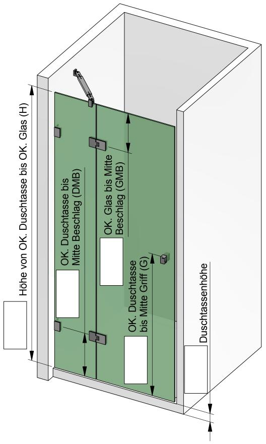
Name\_ Kommission \_\_\_\_\_ P+S-Auftragsnr. Kd-Bestellnr. Auftrag erteilt \_\_\_\_\_ Liefertermin \_\_\_\_ Glasart \_\_\_ **Zutreffendes bitte ankreuzen:** Beschlagsoberfläche: ZN5 (glanzverchromt) ZN1 (mattverchromt) ZNPVD22 (Edelstahlfinish)
