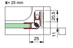
c) mit Dichtprofil 8855KU0-8 und Türanschlag-Trägerprofil 8880
