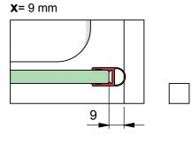
b) mit Dichtprofil 8851KU0-8 und Türanschlag-Trägerprofil 8880
