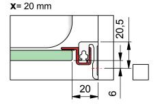
d) mit Dichtprofil 8861KU0-8 und Türanschlag-Trägerprofil 8880
