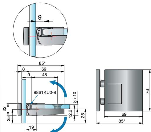
Glasbearbeitung für 8 mm mit Dichtprofil 8861KU0-8-2500
