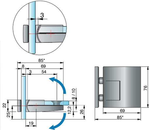
Glasbearbeitung für 8 mm ohne Dichtprofil
